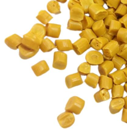
Gránulos reciclados de polipropileno provenientes del post-consumo, lavado, filtrado y descontaminado al vacío, con masterbatch. Corte en discos homogenizado.
